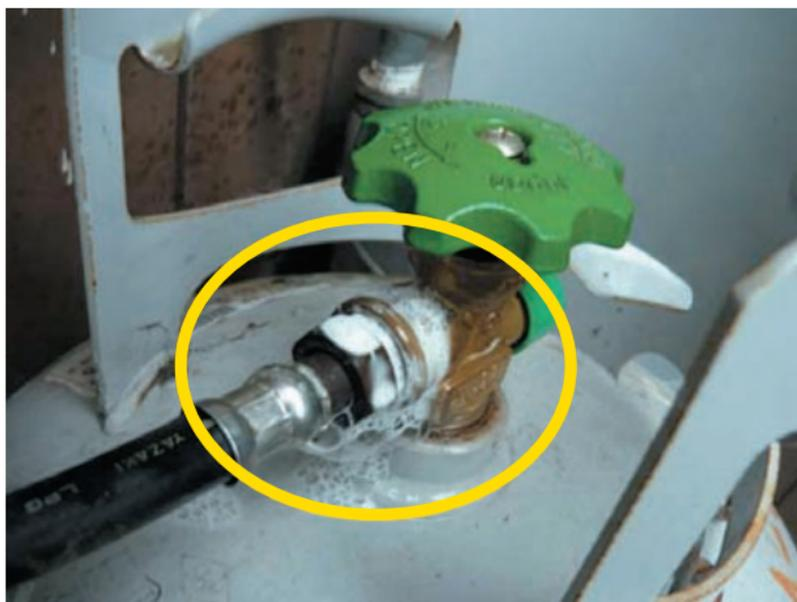
漏れ検査液によるガス漏れ確認
