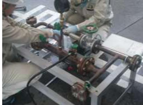
配管漏洩時の措置実習
