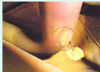
均圧配管が接していた配管(損傷部)
